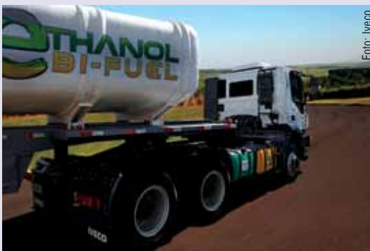
A tecnologia aplicada no caminhão permite a substituição do diesel pelo etanol em taxas variáveis de acordo com a utilização do veículo, podendo chegar a 85% em certos regimes
